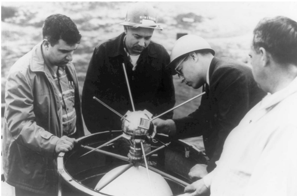
Figura 3.42. El satélite Vanguard fue lanzado el 17/03/1958, siendo el segundo satélite artificial americano puesto en órbita alrededor de la tierra. El satélite era una pequeña esfera de 1,47 kg, equipada con dos transmisores de radio. En la fotografía, que corresponde a una prueba previa al lanzamiento, se observa las pequeñas placas fotovoltaicas sobre la esfera. Fotografía: Britannica.
