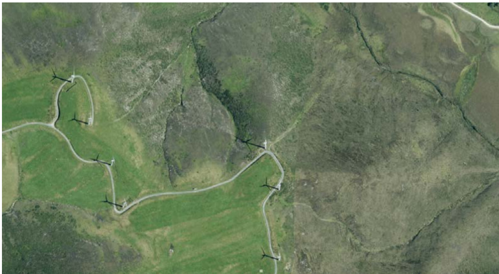
Figura 8.31. Parque Eólico en la parroquia de Montouto (Abadín, Lugo). En el centro de la figura el aerogenerador de la cumbre de As Toxeiras (ZEC Serra do Xistral, Zona Núcleo de la Reserva de Biosfera de Terras do Miño), desde la plataforma que rodea el equipo, se establece el punto de evacuación del agua que discurre por la ladera hasta el fondo del valle del río Eume, relleno por una extensa turbera alta. En la imagen inferior se observa la pluma de erosión que surge hacia el borde superior derecho de la imagen. Fuente: Imágenes PNOA, 2020 y Servicio de Información Xeográfica da Xunta de Galicia.
